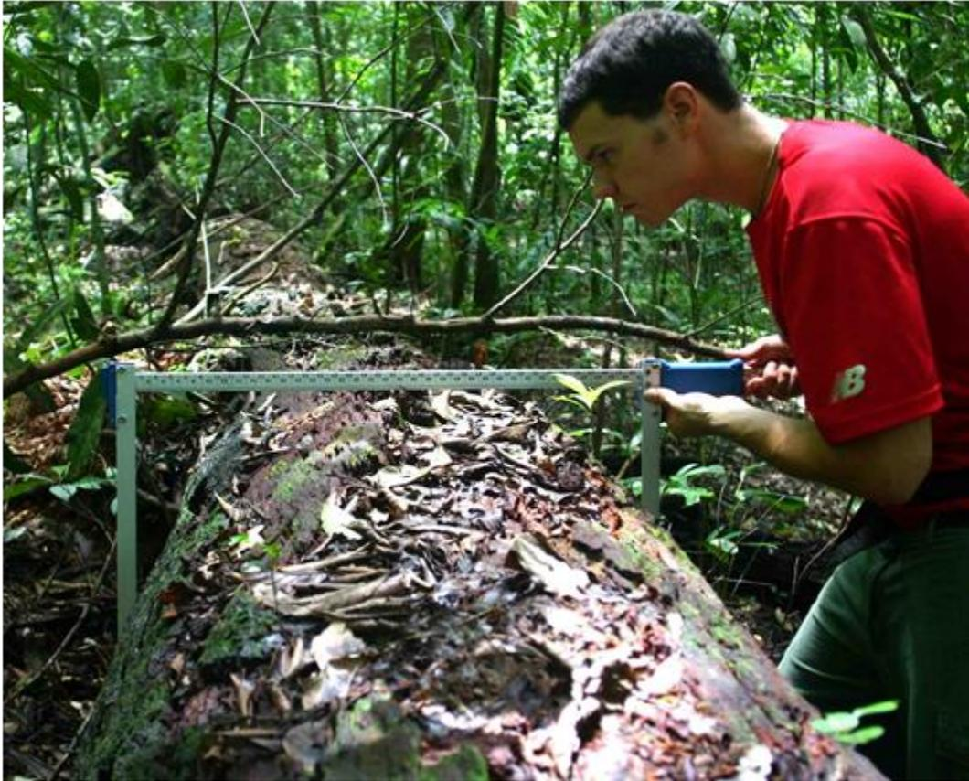
Foto 3. El diámetro de una pieza de desechos forestales se mide utilizando un gran pinza. Debido a que las dos hojas de la pinza curvas fácilmente, se debe tener cuidado para aplicar la cantidad correcta de fuerza para que las cuchillas se mantienen paralelas. (Esto puede ser practicada mediante la medición de diámetros de objetos pequeños, tales como palos, colocándolos en varias posiciones entre las cuchillas mientras se observa si las cuchillas son paralelos.)
